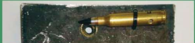
Cal 223(5.56x45mm) Rem. - BP - 15mm / 300HH - 100m
